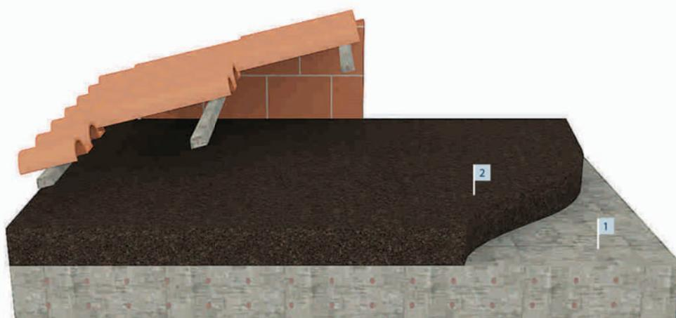
1. Dalle de béton > 20cm    2. Granulés de liège expansé ou panneau de liège expansé
